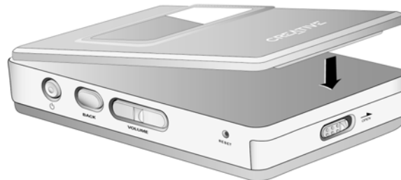
Figuur 2-3: De afdekplaat vastzetten
