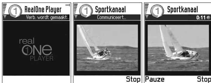
Figuur 3 Streaming van een bestand vanaf het Internet: verbinding maken, opslaan in buffer en afspelen
