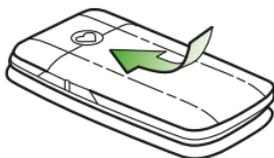
Schieben Sie die rückwärtige Abdeckung in Richtung Herz-Symbol nach vorne, bis die Abdeckung einrastet.
