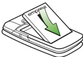
Setzen Sie den Akku so ein, dass sich die goldenen Kontakte (Akku und Telefon) rechts oben berühren.
