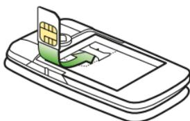
Die Halterung für die SIM-Karte befindet sich in in der oberen rechten Ecke.
